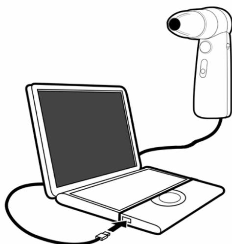
コンピュータ本体の USB ポートに、USB マイクロスコープのコネクタを差し込みます。
